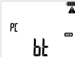
3. Verbinden Sie das Bluetooth Modul über die USB-Schnittstelle mit dem PC, falls es ist nicht mit PC integriert.
