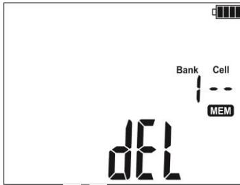
... die Nummer der Zelle verschwindet, und es erscheint ein Symbol, **del** das die Bereitschaft zum Löschvorgang signalisiert.
