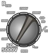
Der Drehschalter zur Funktionsauswahl sollte auf einer der Positionen eingestellt werden  $R_{ISO}$ , mit gleichzeitiger Auswahl der Messspannung (Position **50...5000V** alle 10V in dem Bereich gewählt 50 V...1 kV je 10 V, 1 kV...5 kV je 25 V). Das Messgerät befindet sich im Modus zur Spannungsmessung.
