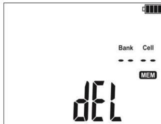
...die Nummer der Datenbank verschwindet, und es erscheint das Symbol **del** das die Bereitschaft zum Löschvorgang signalisiert.
