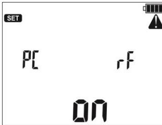
2. Verbinden Sie das OR-1 Modul über die USB-Schnittstelle mit dem PC, drücken Sie die Taste **ENTER**.
