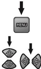
Durch Drücken der Taste **MENU** kann zur Auswahl der maximalen Messspannung, Dauer jeder der fünf Messungen und des Kurzschlussstroms  $I_{SC}$  gewechselt werden.
