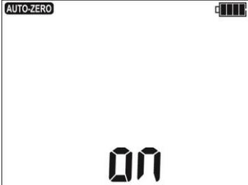
Die Meldung **AUTO-ZERO 00** erscheint und zeigt an, die Messkabel kalibriert wurden, danach wechselt das Messgerät in dem Messmodus. Die Aufschrift **AUTO-ZERO** bleibt während der Messung vorhanden. Die Kompensation ist auch nach Ausschalten und erneutem Einschalten des Messgeräts aktiv.
