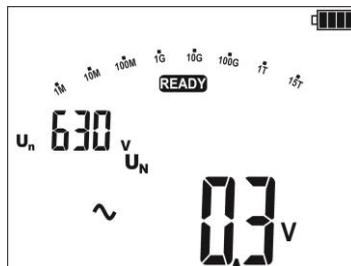
Das Messgerät ist bereit zur Messung.
